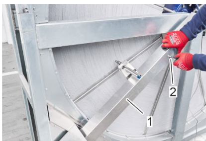
Figura 56: Fijación de la cubierta del riel de limpieza
